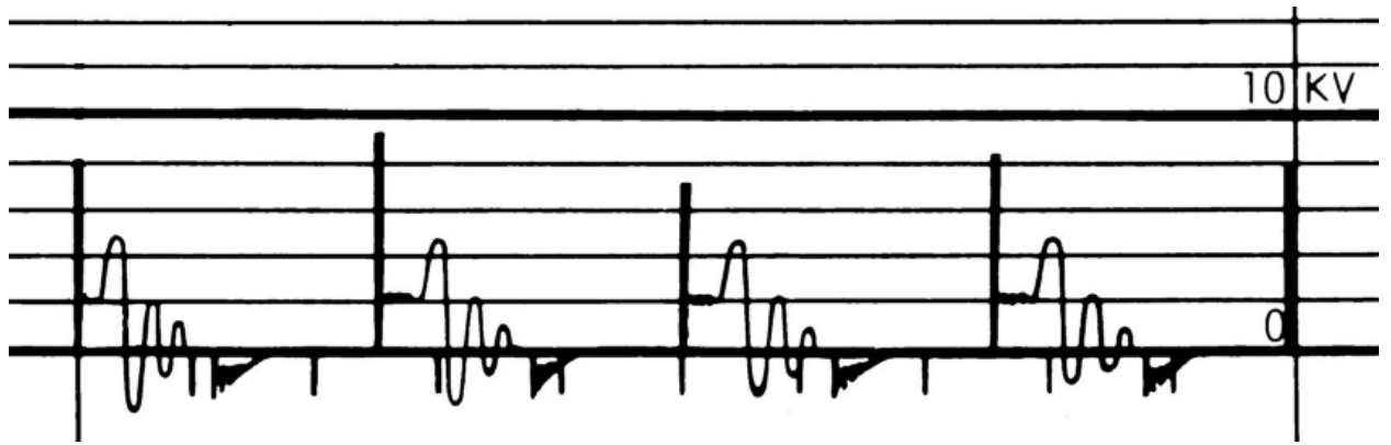
Рис. 10. Измерение напряжения зажигания.
